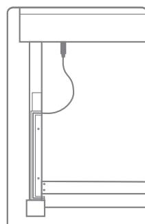
脚踏板连接线安装示意图
